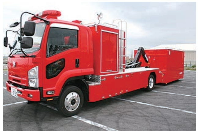
大型除染システム搭載車
